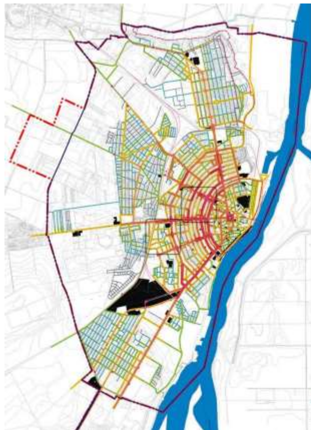
Figure 39 Accesibilitatea tramei stradale în Brăila ( rosu – cel mai accesibil, albastru – cel mai puțin accesibil), sursa: autorii, 2012
